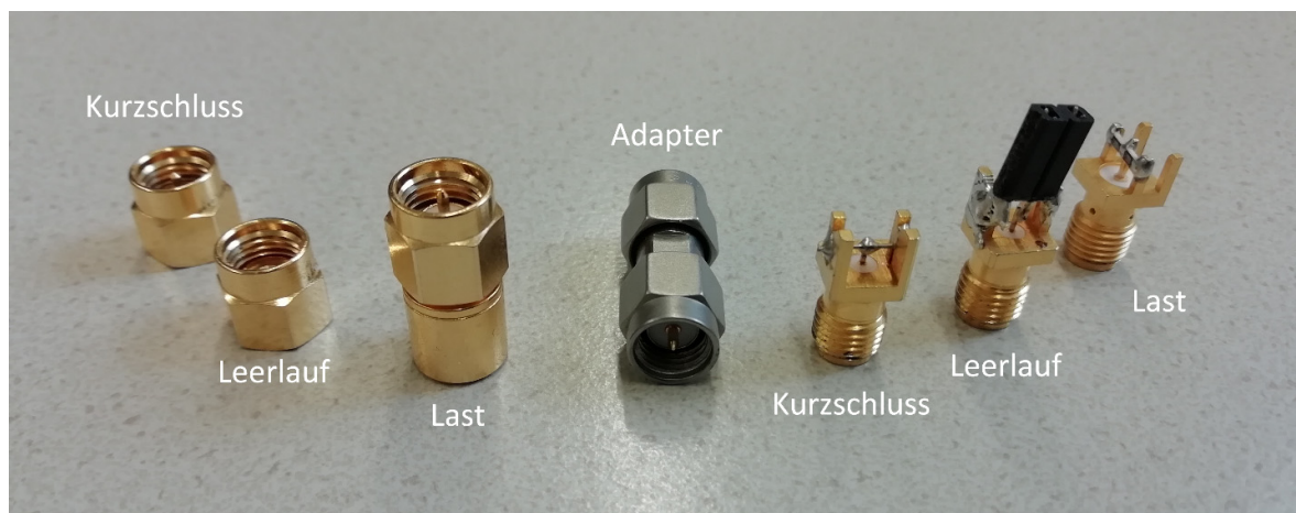
Abbildung 51: VNA Kalibrationskit, links Professionell für SMA-Stecker, rechts Selbstgebaut für SMA-Buchsen. Quelle: Eigene Darstellung.
