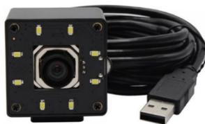
Abb. 45: ELP-USB4K02AF-KL100W SONY-IMX415-4K-UHD-USB-Kamera mit *Auto Focus*,
