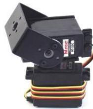
Abb. 44: Lynxmotion-Lynx-B-Schwenk-/Neigesystem,
