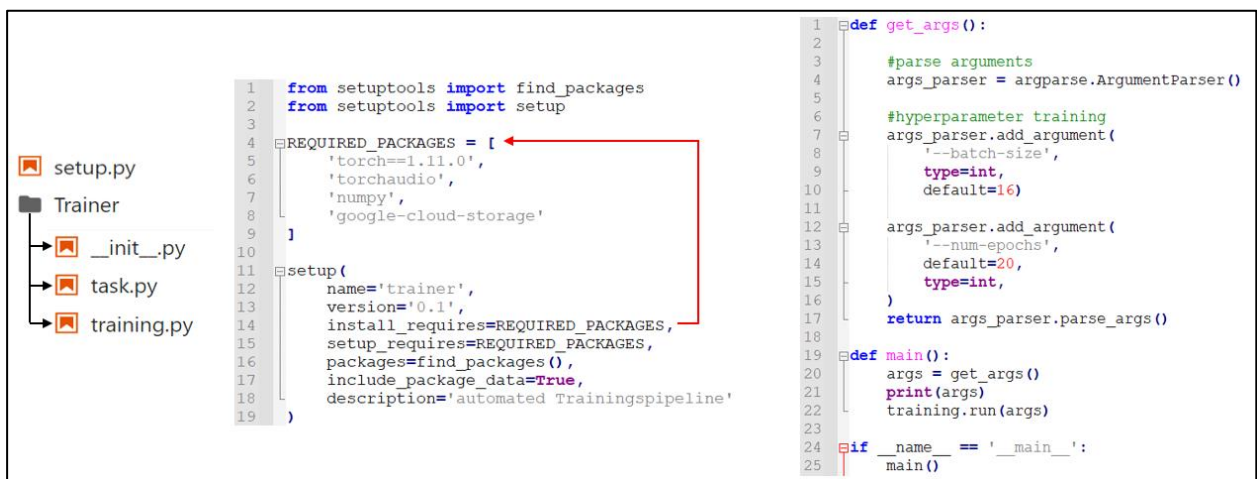
Abbildung 52: Dateistruktur Trainingspipeline für das automatisierte Training (links), Inhalt der setup.py -Datei (Bildmitte) und Ausschnitt aus der Datei task.py (rechts), Quelle: Eigene Darstellung.
