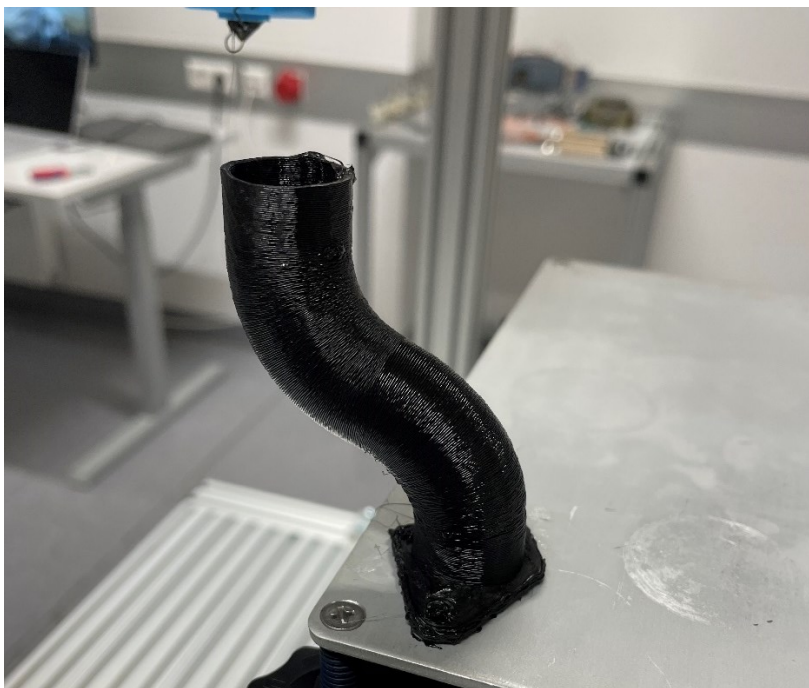
Abbildung 61: Drucktest am Beispiel des Rohrkrümmers, Quelle: Eigene Darstellung.
