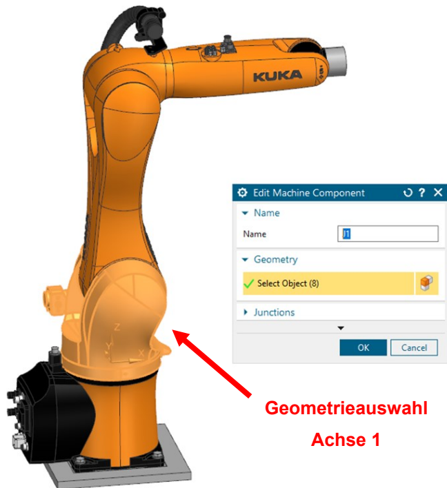
Abbildung 32: Auswahl der zugehörigen Geometrie zur Bestimmung der Achse 1, Quelle: Eigene Darstellung.
