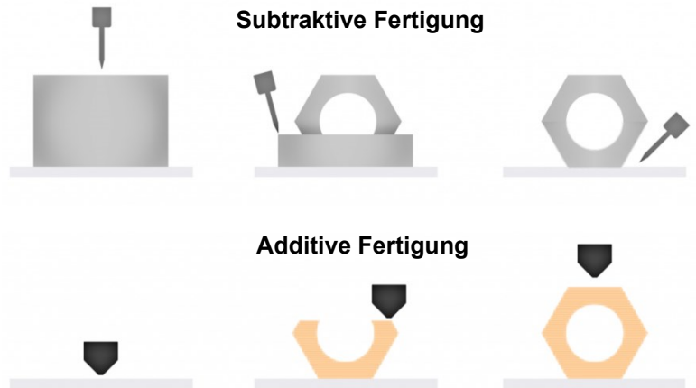
Abbildung 1: Unterschied zwischen additiver (unten) und subtraktiver (oben) Fertigung, Quelle: Surfaceid Corp. (2018), Online-Quelle [15.09.2022] (leicht modifiziert).
