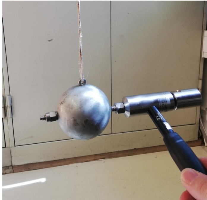
Abbildung 3: Stoßkalibrierung mittels Kraftmesshammer, Quelle: eigene Darstellung (2022).
