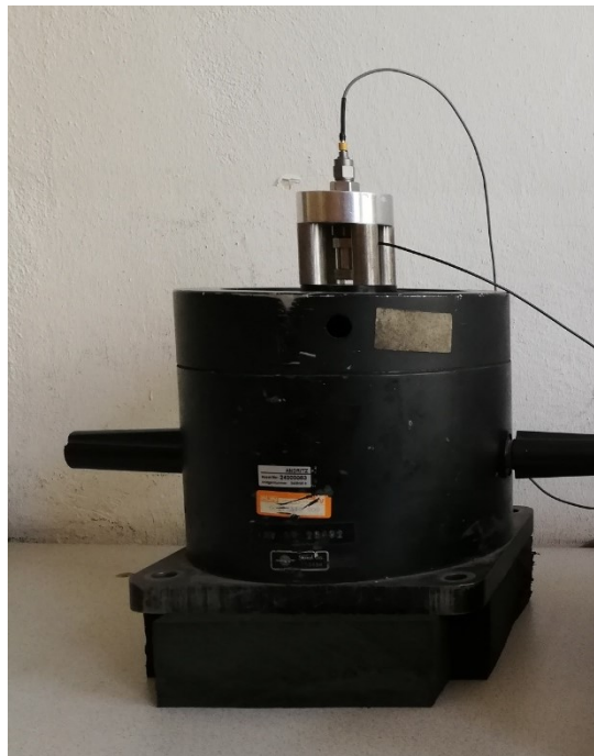
Abbildung 6: Shaker mit Vergleichsmessaufbau, Quelle: eigene Darstellung (2022).
