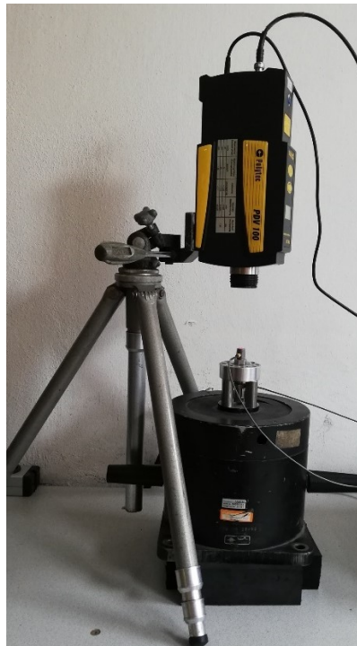
Abbildung 5: Messaufbau Absolut-Verfahren, Quelle: eigene Darstellung (2022).
