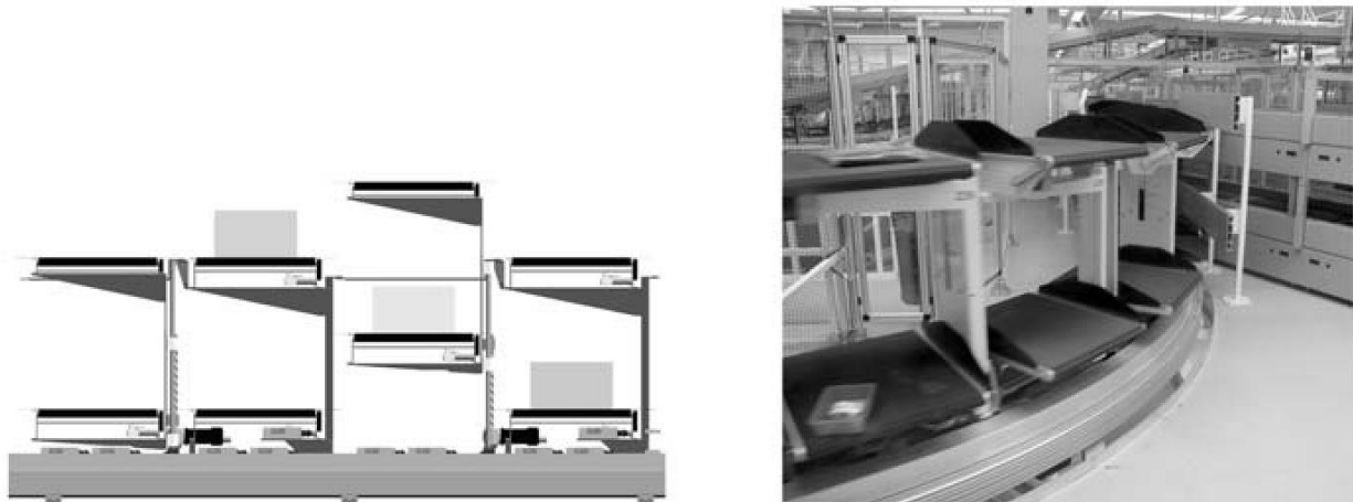
Abbildung 34: Doppelstockquergurtsorter von BEUMER, Quelle: Arnold/et al. (2006), S. 151.
