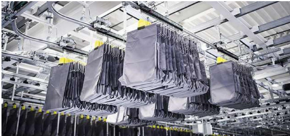
Abbildung 25: Taschensorter mit vollautomatischer Taschenentladung, Quelle: psb intralogistics GmbH (o.J.), Online-Quelle [29.03.2019]
