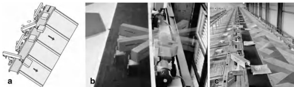
Abbildung 16: Drearmsorter. a Skizze, b Bewegungsphasen, c Einsatzbeispiel, Quelle: Jodin/ten Hompel (2012), S. 96.
