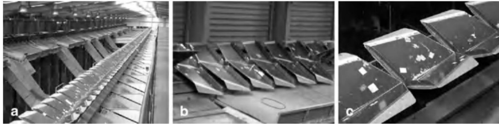
Abbildung 15: Schwenklappensorter im DPD-Depot 160 in Raunheim. a Endstellen, b Abwurfstellung, c Transportstellung, Quelle: Jodin/ten Hompel (2012), S. 75.
