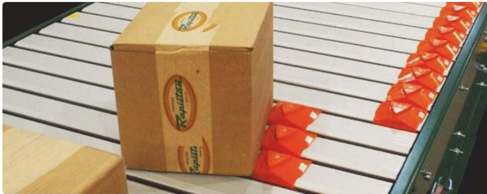
Abbildung 13: Tragplattenband: Ausschleusen von Paketen mit Ausschleusschuhen nach einer Seite, Quelle: Martin (2014), S. 205.
