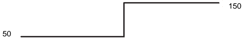
Abbildung 17: Ideale Kante anhand eines Grauwertes, Quelle: Hermes (2005) (leicht modifiziert), S. 70.
