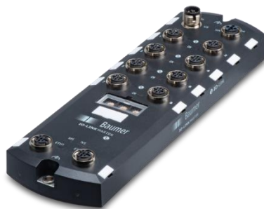
Abb. 21: IO-Link Master mit 8 Class A Ports von Baumer, Baumer Electric AG (2022), Onlinequelle [23.02.2022].
